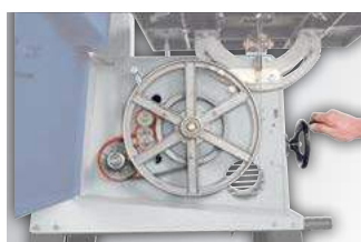
قابلیت تنظیم سرعت برش از ۳۷۰ تا ۷۵۰ متر بر دقیقه به صورت مکانیکی
