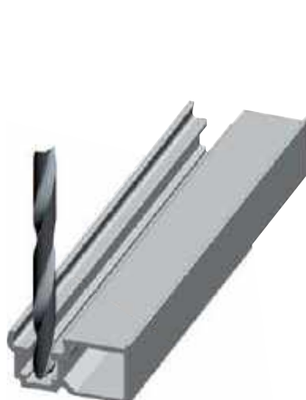
سوراخ کاری پروفیل آلومینیومی
