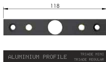
الگوی سوراخ‌کاری برای نگهدارنده طبقات حجیم تریاد ماکسی و برکت دیواری
